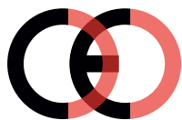
Falsche CE-Kennzeichnung (zu dicht)
