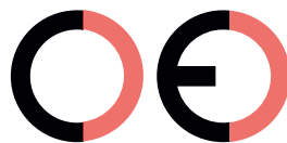
Falsche CE-Kennzeichnung (zu großer Zwischenraum)
